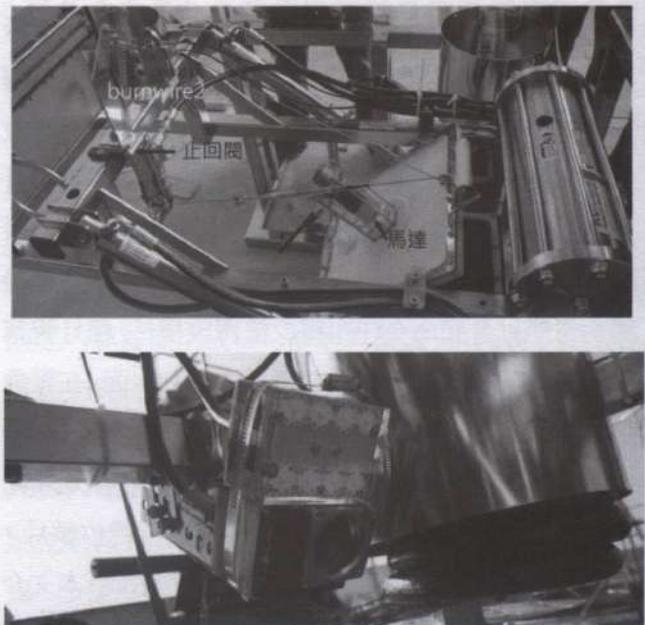
圖三：通量艙的作動系統[上圖]及深海縮時攝影系統[下圖]。
