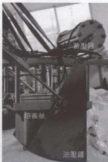
圖一：密閉罩蓋法測量底泥生物呼吸作用過程中消耗的氧氣量。顆粒有機碳(POC)沉降到海床，除了少部分難被分解的有機碳會被永久埋藏，大多顆粒有機碳在深海沉積物與海水交界會被微生物透過呼吸作用分解再礦化為二氧化碳或水解成溶解態有機碳(DOC)釋放回水體中。透過安裝在培養艙內部的溶氧探針可以估計沉積物群聚耗氧率，以及估計降落到海床上的顆粒有機碳通量。右圖為安裝在深海著陸器上的箱形沉積物採集器。
